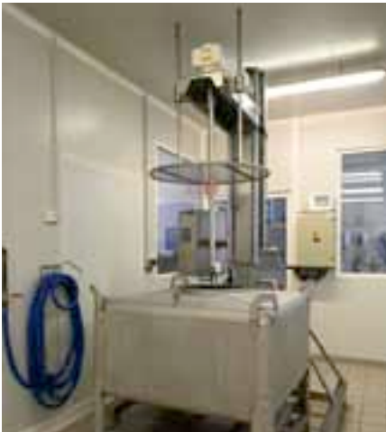
La souche initiale est déposée dans une cuve de 500 litres et mélangée à d'autres ingrédients à l'aide d'un agitateur.
